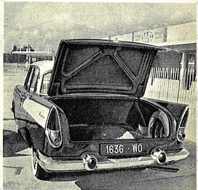
Le coffre arrière de la Beaulieu est très vaste. Les pare-chocs sont pourvus de butoirs en caoutchouc.
